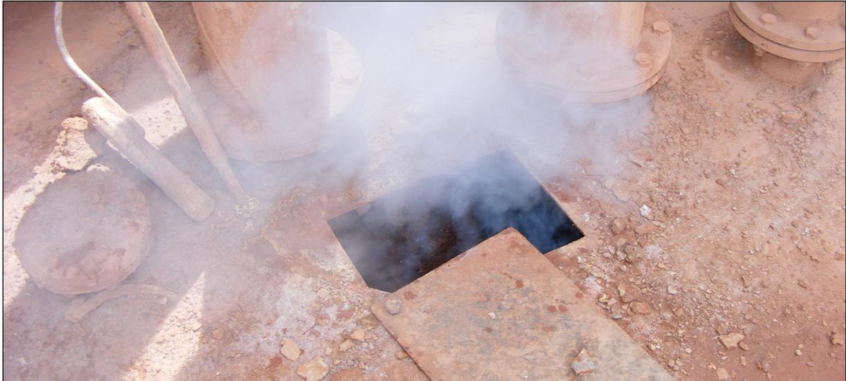
**Photographie 11 : Trappe de prélèvements des cyclones 1 et 2**
