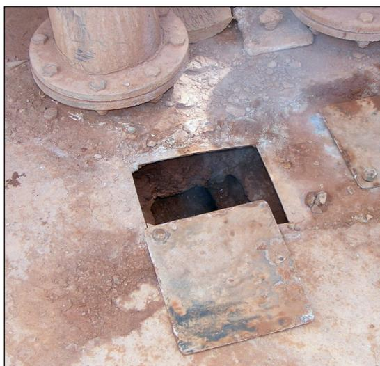
Photographie 9 : Trappe de prélèvement du cyclone 4
